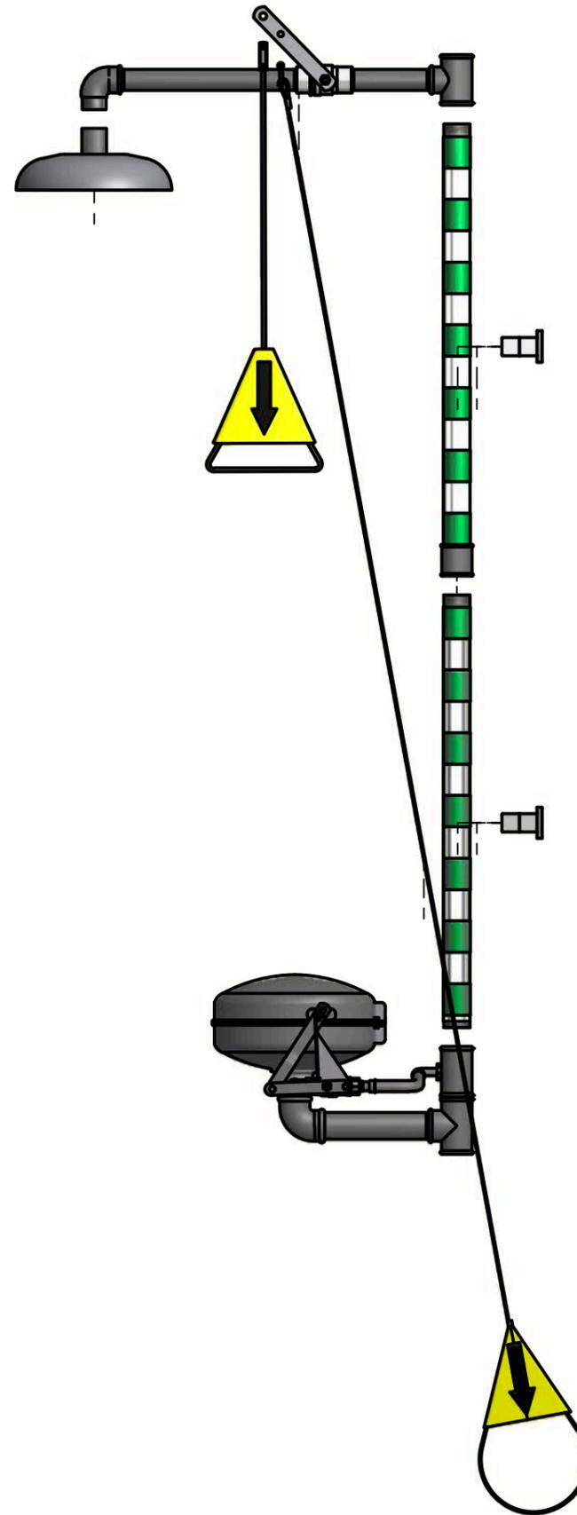
**Min flow: 78 + 20 l/min**
