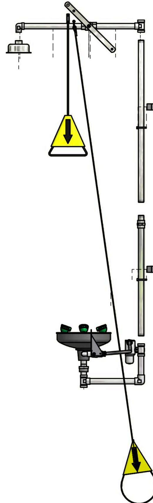
Min flow: 78 + 20 l/min
